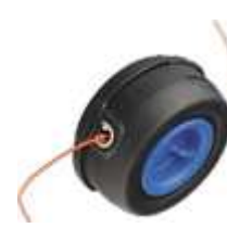
578 44 74-01 Trimmerhuvud S35 Trimmerhuvud med manuell trådmatning. Användaren matar ut tråden manuellt genom att trycka på trådmatningsknappen och dra i tråden.
